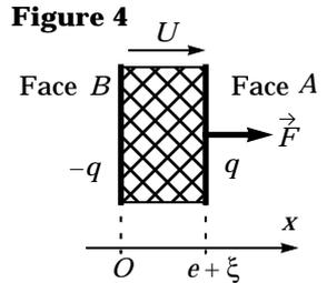
La face  $B$  est fixée à l'abscisse  $x = 0$ . Au repos, l'épaisseur de la lame vaut  $e$ , et ses faces ne sont pas chargées. En présence de sollicitations extérieures (soit une différence de potentiel  $U = U_A - U_B$  appliquée entre les faces, soit une force  $\vec{F} = Fu_x$  appliquée sur la face  $A$ , soit les deux simultanément) :
