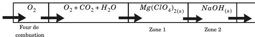
Dans la zone 1, le perchlorate de magnésium anhydre  $Mg(ClO_4)_2(s)$  capte la vapeur d'eau ; dans la zone 2, l'hydroxyde de sodium capte le dioxyde de carbone. Il en résulte une augmentation de la masse des zones 1 et 2.
