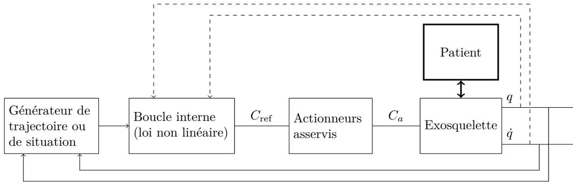
Figure 13 Structure de commande
