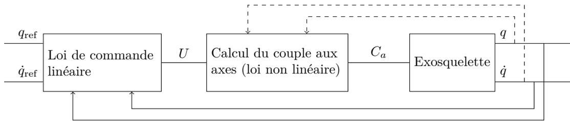
Figure 16 Structure de la commande « deux axes »
