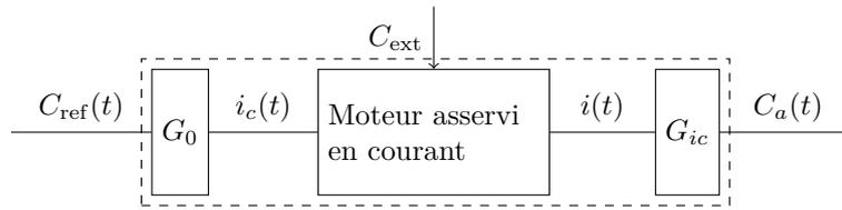
Figure 11 Schéma de l'actionneur
