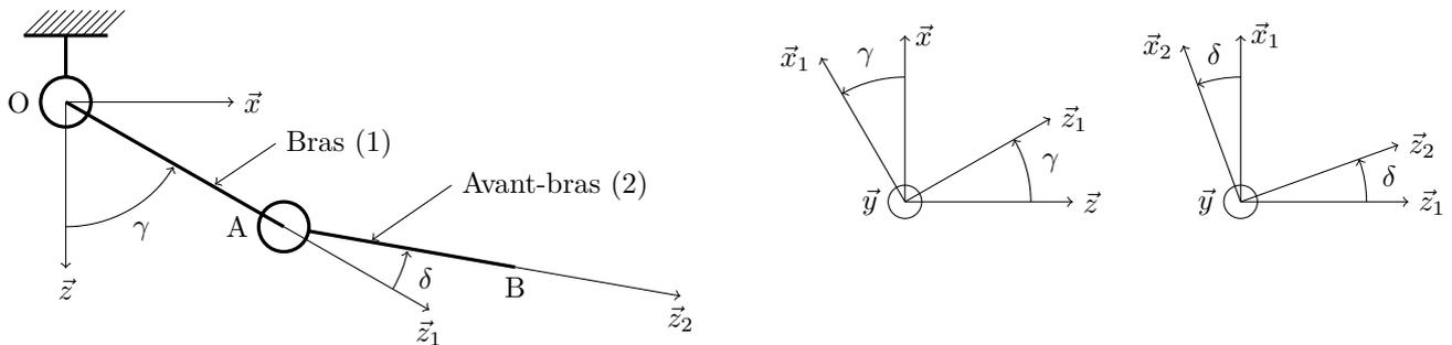
Figure 14 Paramétrage du problème dynamique plan considéré
