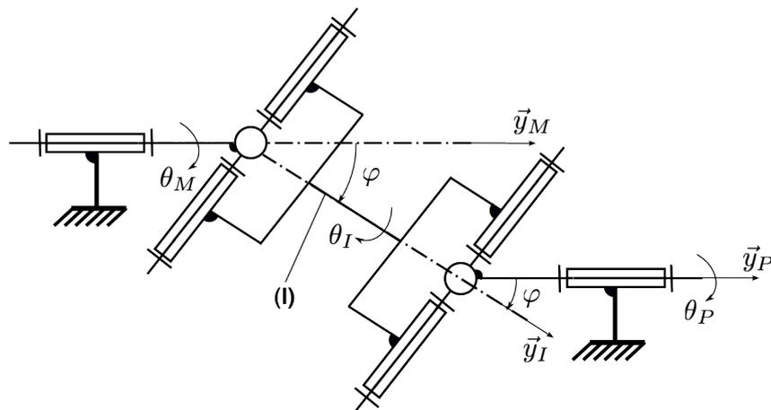
**Figure 8** Disposition des deux joints de Cardan dans la transmission étudiée
