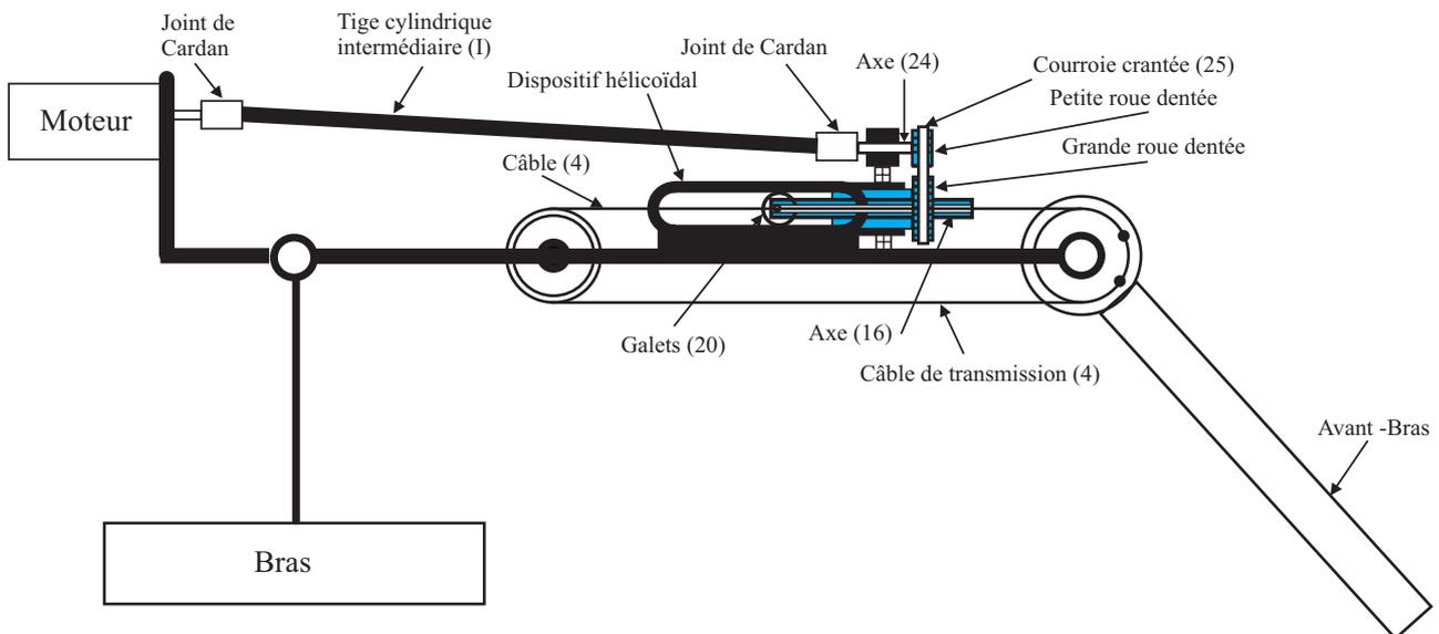
Figure 6 Schéma de principe de la transmission
