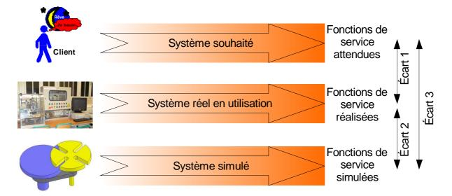
Cette démarche consiste à vérifier les performances attendues d'un système complexe (quantification de l'écart 1), à valider une modélisation à partir d'expérimentations (quantification de l'écart 2) et à prévoir les performances d'un système à partir d'une modélisation (quantification de l'écart 3).
