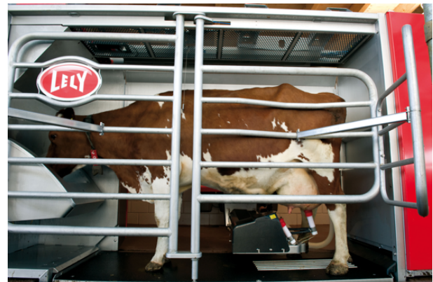
Figure 2 Vache en phase de traite et d'alimentation dans le box du robot de traite LELY Astronaut A3 (d'après plaquette LELY)
