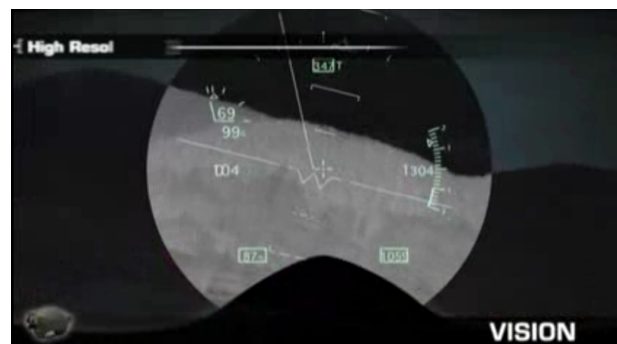
Figure 2 Vision nocturne et affichage des informations de vol
