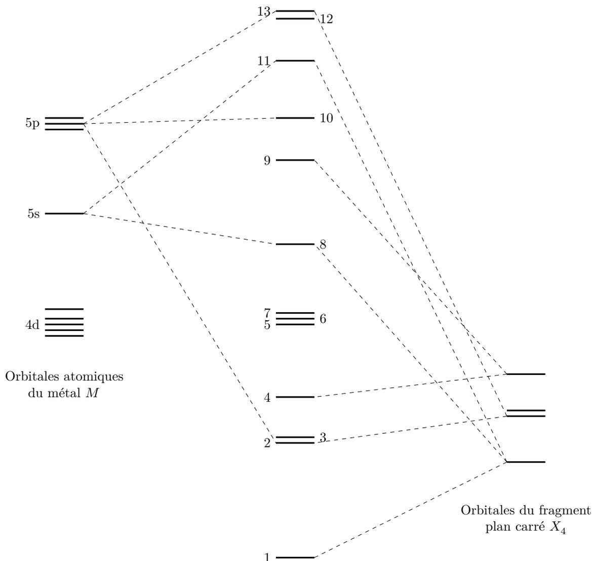
**Figure 4** Diagramme d'orbitales moléculaires du complexe  $MX_4$  obtenu par la méthode des fragments (les pointillés représentant les contributions des orbitales atomiques d du métal  $M$  n'ont pas été représentées)
