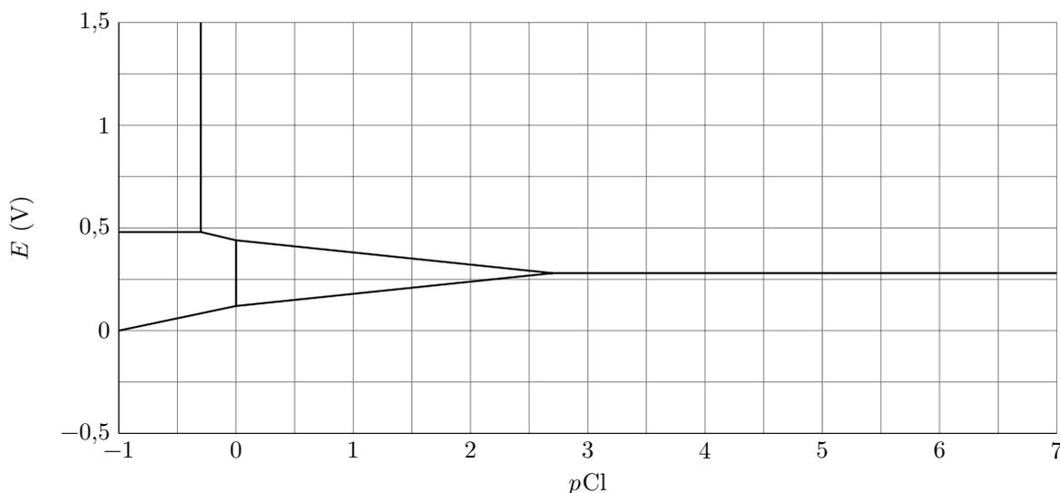
**Figure 1** Frontières du diagramme  $E - p\text{Cl}$  du cuivre
