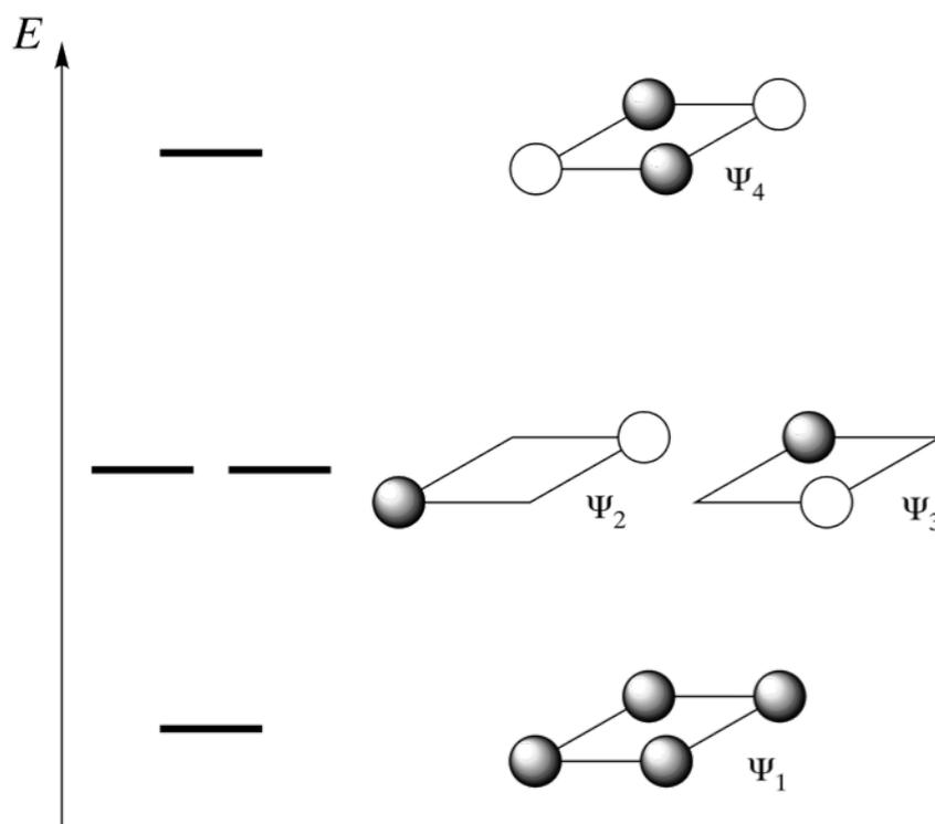
**Figure 3** Orbitales d'un fragment « plan carré »  $X_4$
