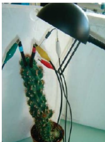
Figure 7 Dispositif expérimental et évolution des courants dans chacune des électrodes de carbone mesurés avec une contre électrode de platine
