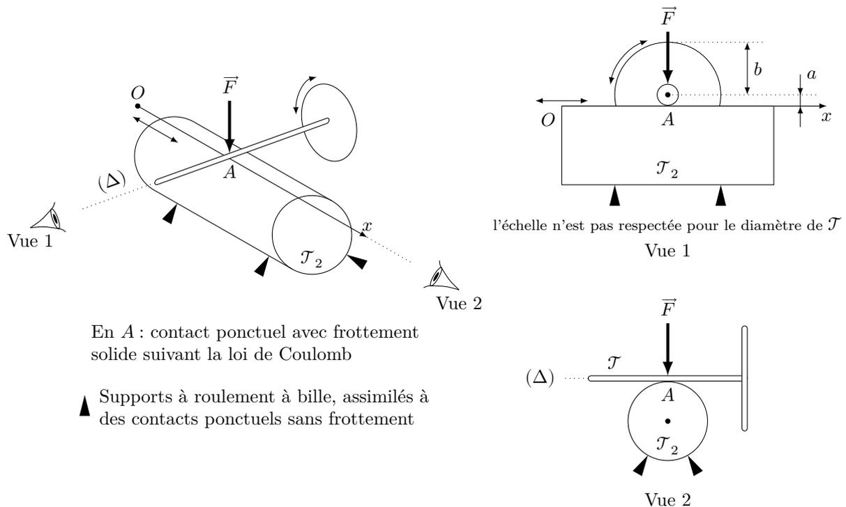
Figure 8 Schéma simplifié du porte oculaire Crayford
