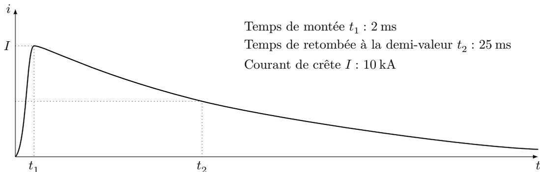
**Figure 2** Enregistrement de l'intensité électrique d'un coup de foudre
