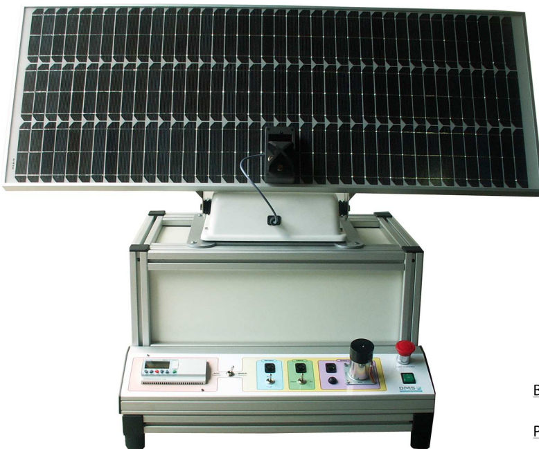
Fig 1 : Vue d'ensemble du panneau solaire asservi
